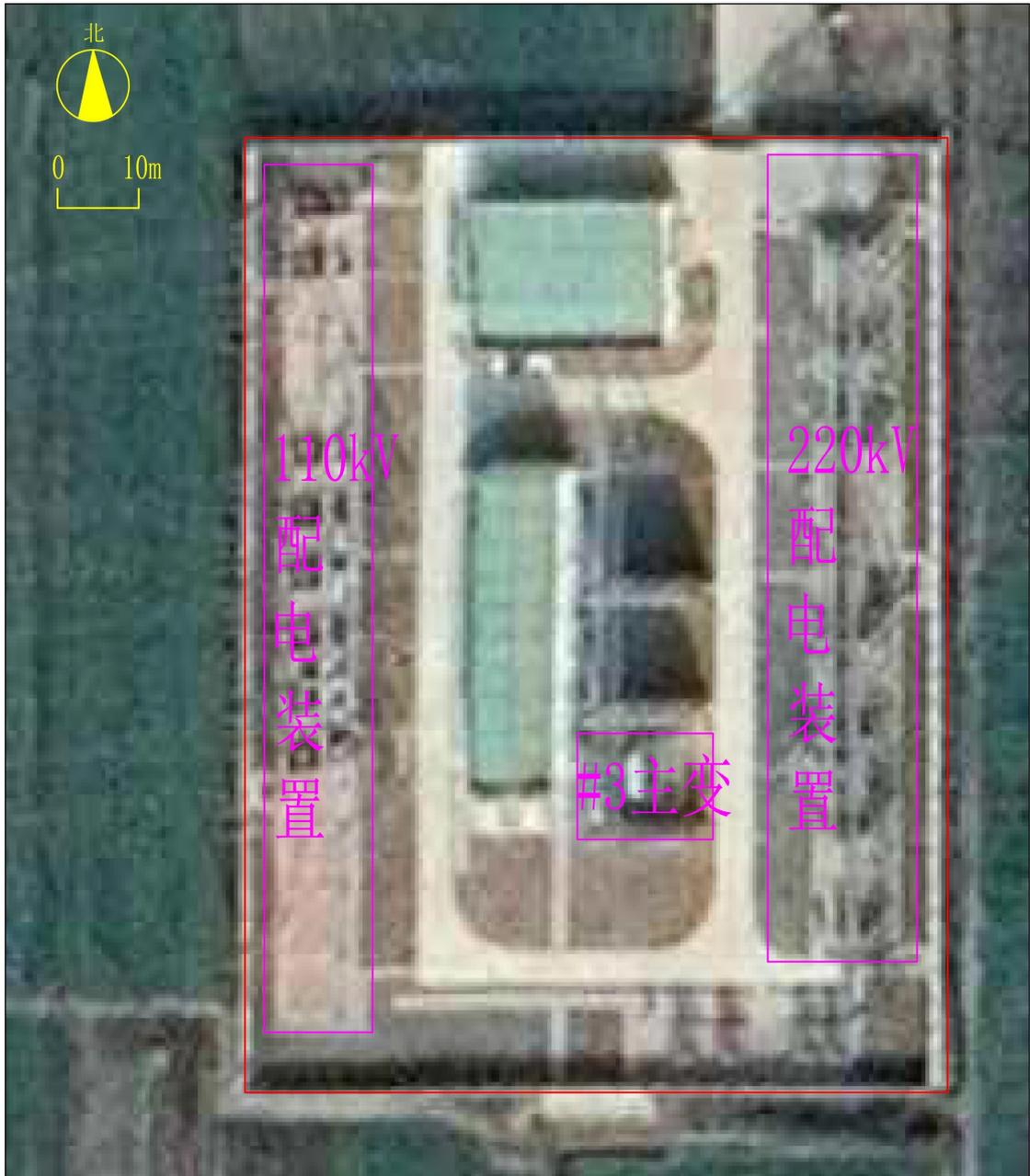
图 3-1 220kV 卢廷变平面布置图
