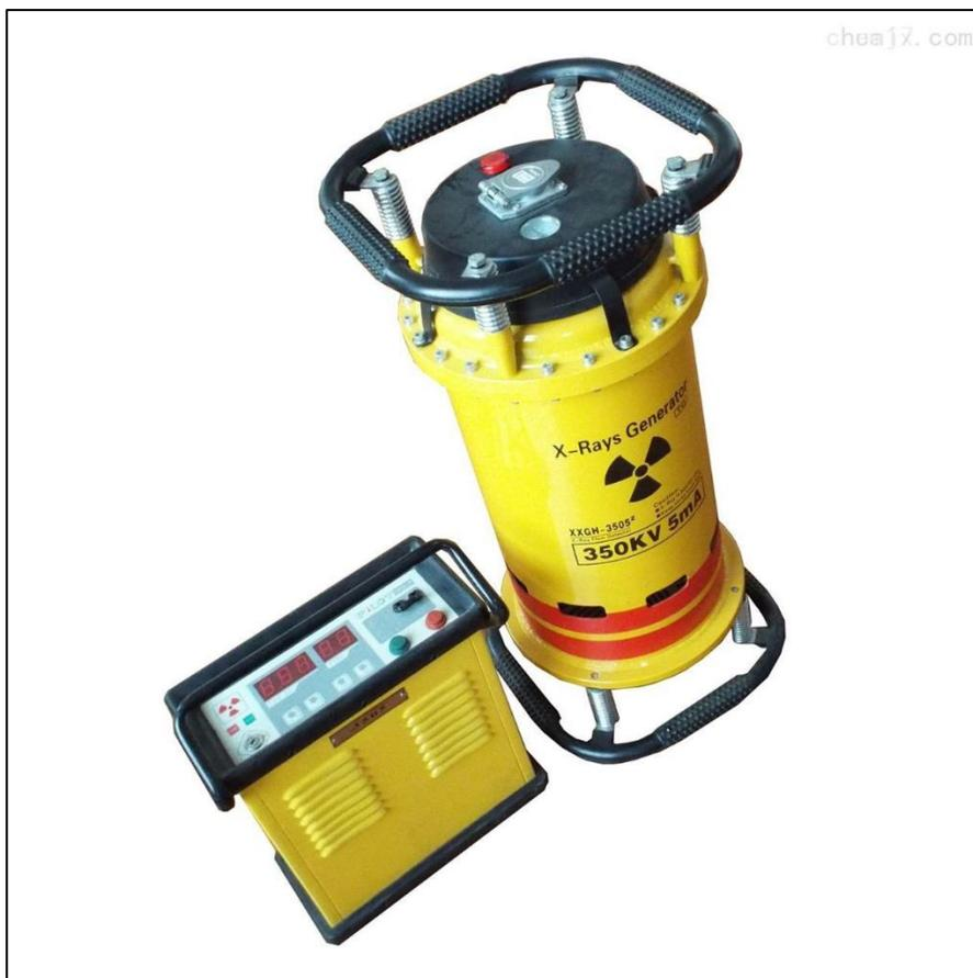
图 9-1 常见 X 射线探伤机外观示意图
